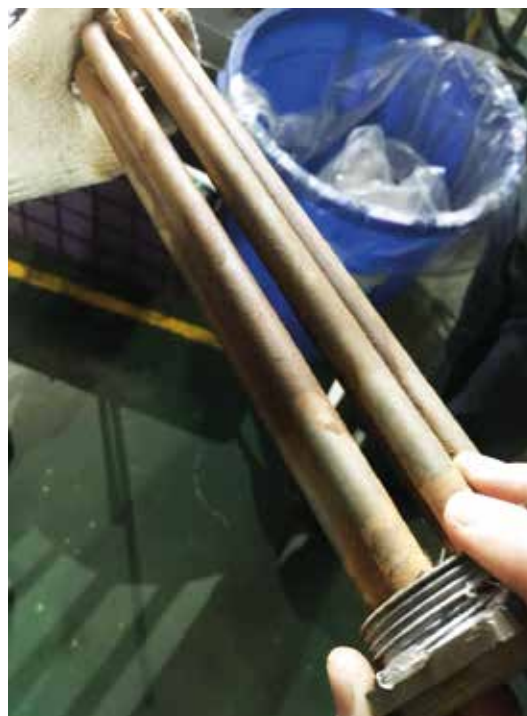
安装沃肯(Vulcan)一年半后未清洗的换热器
