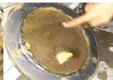
换热器内部。冷凝器端板已经失去了之前的所有结垢。(底部的光点是反光)
