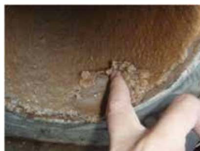
循环管中的水垢用手指就可以轻松取出
