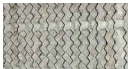
沃肯(Vulcan)安装5个月后: 水垢已经变少
