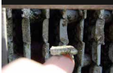
二氧化硅无法用水冲刷掉, 但能用趾甲剥掉。
