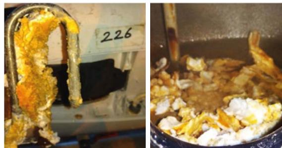
**Photos 2 et 3.** Le calcaire enveloppant autrefois l'élément chauffant et le réservoir de puisard. (photos prises dans l'une des chambres de l'hôtel IBMA)
