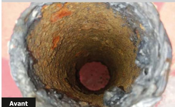
Avant que Vulcan ne soit installé, le tuyau était entartré et rouillé.
