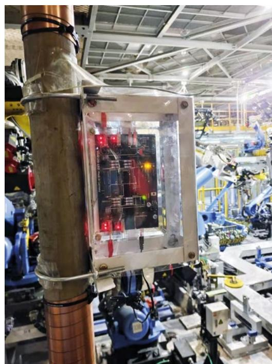
Vulcan S25 a été installé sur la conduite principale du système de l'eau en circulation des robots de production.
