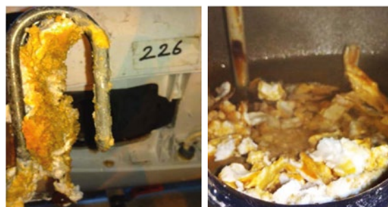
Fotos 2 y 3. Antes la cal cubría la resistencia y el sumidero (la fotografía se tomó en una de los cuartos del hotel IBMA).
