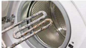
Värmeelement i tvättmaskin
