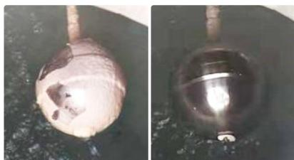
Kuglasti ventil sa plovkom
