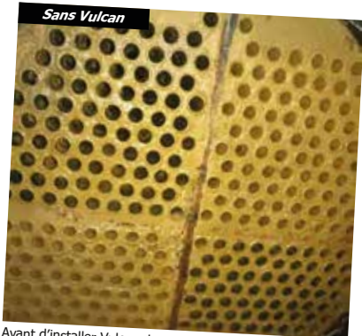
Avant d'installer Vulcan, le calcaire était très épais et dur au niveau des tubes de l'échangeur de chaleur.
