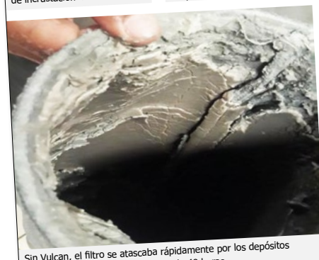
2 semanas después de la instalación de Vulcan, las incrustaciones se habían ablandado y desprendido.
