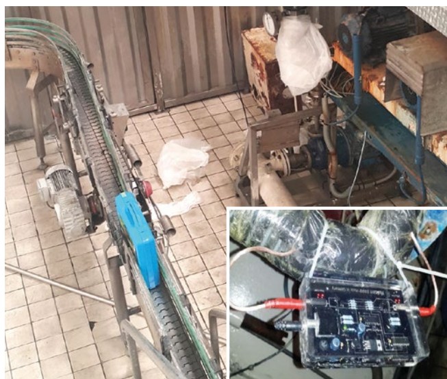
Vulcan 5000 安装在水循环室的进水口
