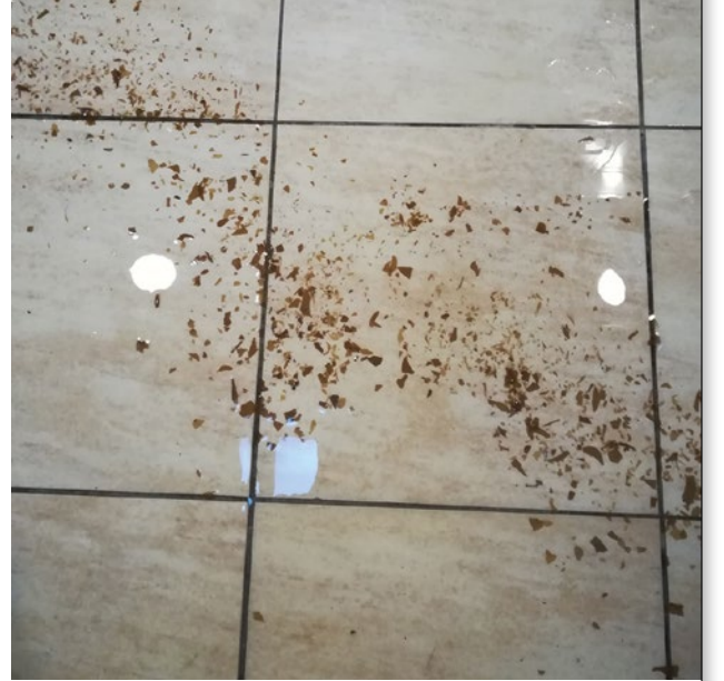
Kireç kırıntısı, Çin mutfağındaki buharlı pişiriciden dışarı atıldı.
