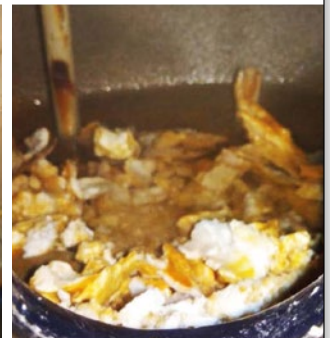
图2和3. 累积在加热元件和储水箱的水垢。(照片取自酒店内的其中一个房间)
