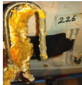
图2和3. 累积在加热元件和储水箱的水垢。(照片取自酒店内的其中一个房间)
