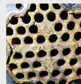
Faisceau tubulaire d'un échangeur de chaleur
