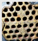
Faisceau tubulaire d'un échangeur de chaleur
