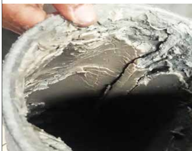
沃肯(Vulcan)安装前, 过滤器很快就会被水垢沉积物堵塞, 并且必须每48小时更换一次。
