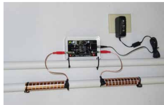
图4：有关物理性水处理方法的基本配置
