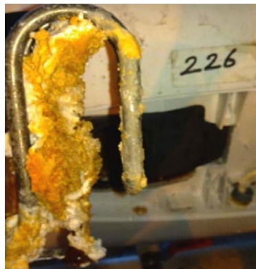
Fotos 2 y 3. Antes la cal cubría la resistencia y el sumidero (la fotografía se tomó en una de las habitaciones del hotel IBMA).
