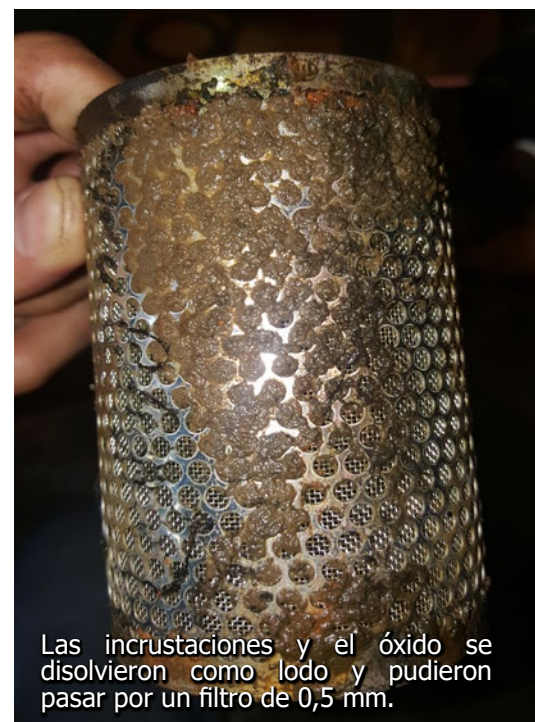
Después de 2 meses de la instalación de Vulcan S25, las incrustaciones y el óxido se volvieron blandas y fangosas.
