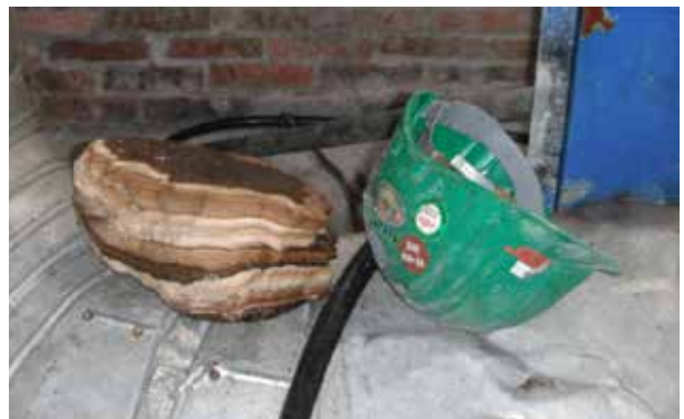
Depósito eliminado de la tubería después de la instalación de Vulcan
