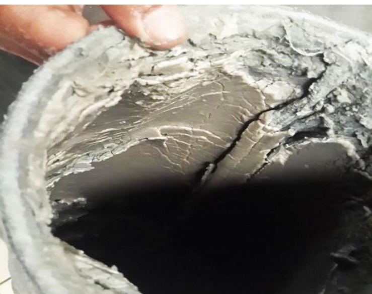
Sin Vulcan, el filtro se atascaba rápidamente por los depósitos calcáreos y tenía que cambiarse cada 48 horas.
