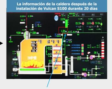
Cuando la presión de operación se mantiene igual, después de 20 días de instalación de Vulcan, la tubería de suministro de agua se ha reducido la presión en 0,12 MPa.
