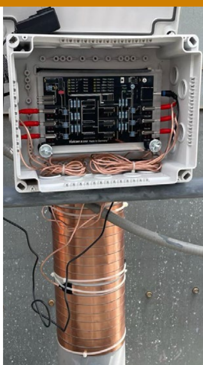
在6英寸（DN150）PVC管道上安装Vulcan S100
