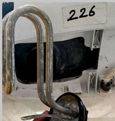
图6和7. 在沃肯(Vulcan)安装后十二周, 水垢已经完全消失。
