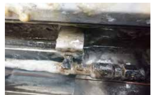
6月13日: 自从Vulcan 5000被移除了1个月, 机器1开始恢复到其初始状态, 漂浮着生物膜。
