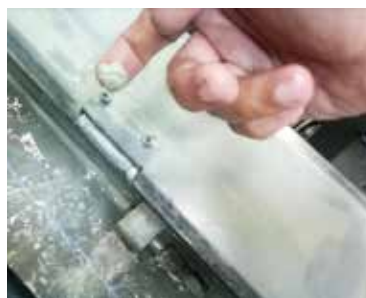
6月13日: 机器2 前安装Vulcan 5000一个月后, 水垢已经溶解, 可以用手指抹掉。
